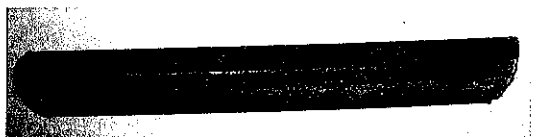
注:钢筋直径为12.60 mm,长度为92.25 mm,表面积为1162.35 mm 2 ,锈积率为0.3%。
